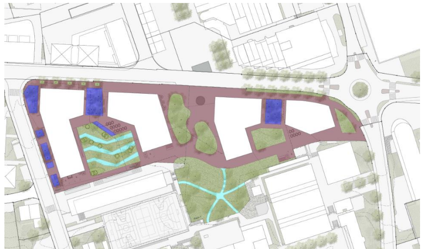
Abbildung: Retentionskonzept, CSP Ingenieure. Blau: Chaussierung, in Schächte entwässert, Türkis: Chaussierung über Schulter entwässert, Braun: Asphalt, Grün: Grünflächen
